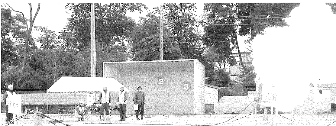
【カートリッジ缶の破裂により、LPガスはこのように燃え広がります】
