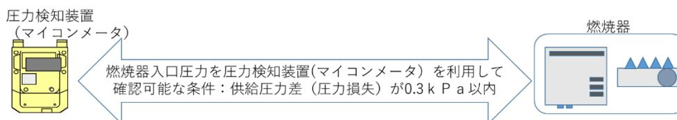
(3) 圧力検知装置（マイコンメータ）を活用した調整器の調整圧力及び閉そく圧力、並びに燃焼器入口圧力の確認方法
