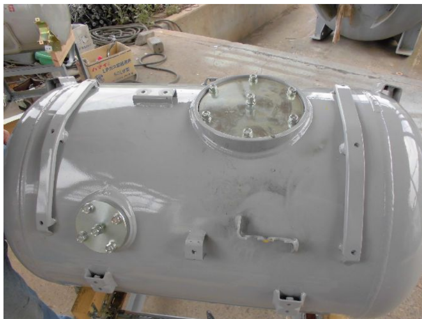
写真10 フランジ取付け
