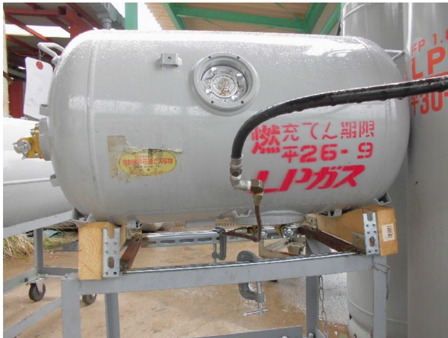
写真2 メインバルブよりガス抜き
