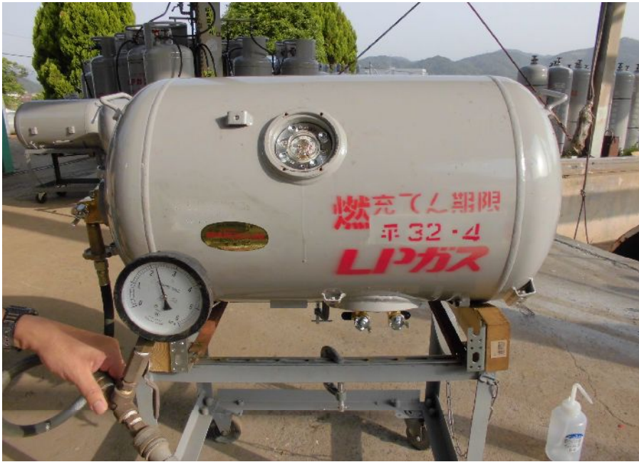
写真6 窒素ガスによる気密試験 2.28MPa
